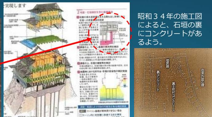
昭和34年の施工図によると、石垣の裏にコンクリートがあるよう。
