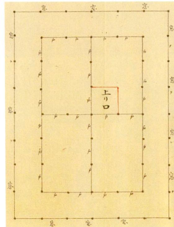
[図2]「御天守地割図」五重平面
