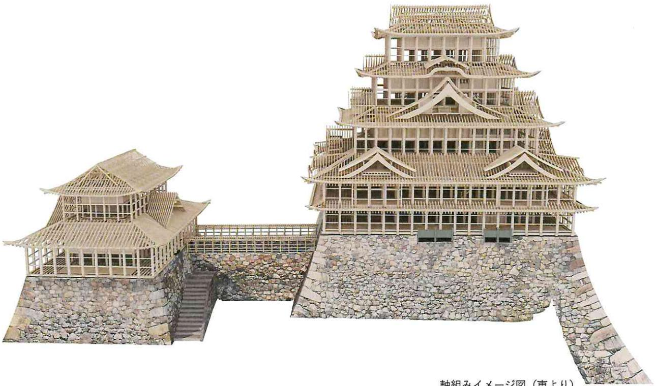
軸組みイメージ図（東より）
