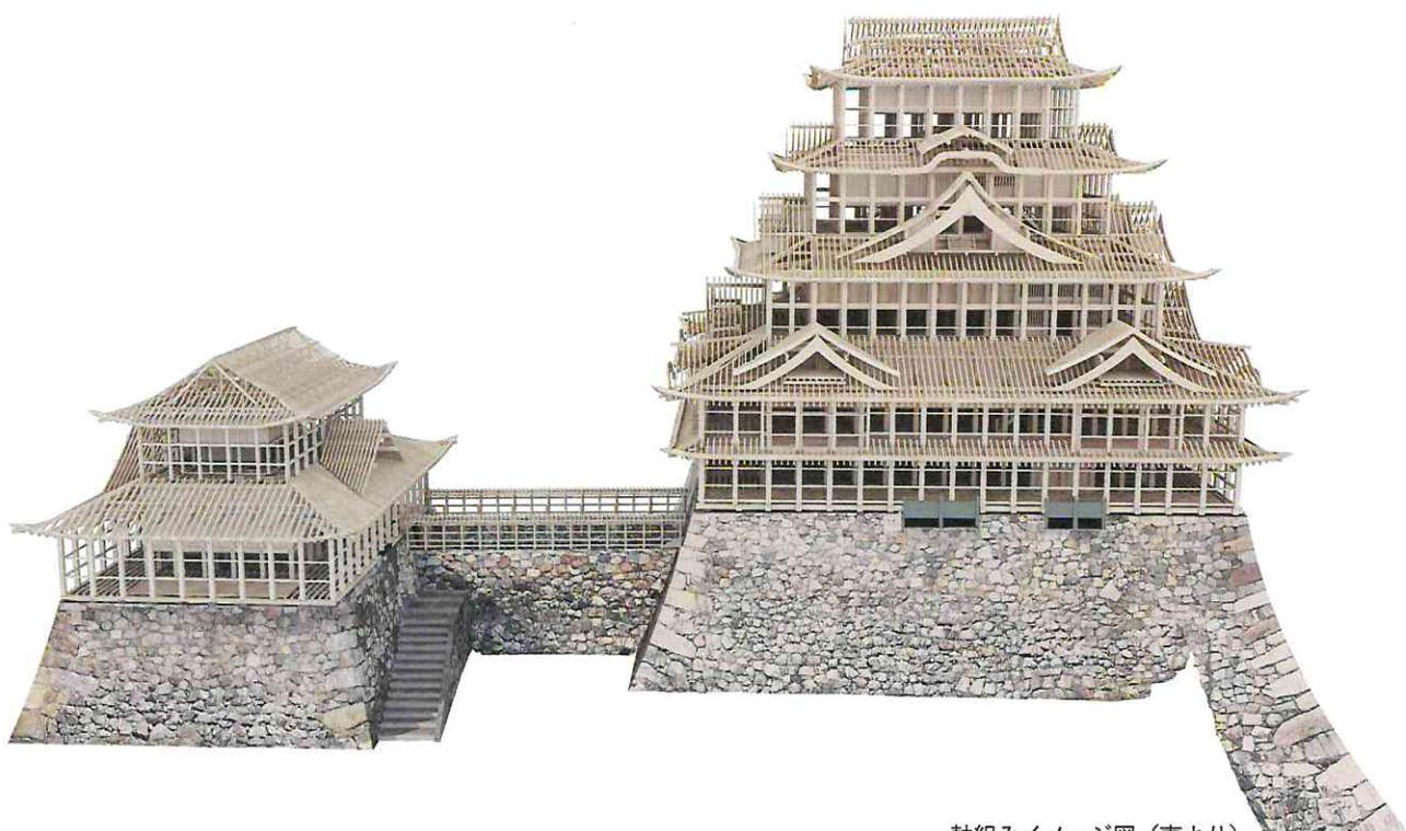
軸組みイメージ図（東より）
