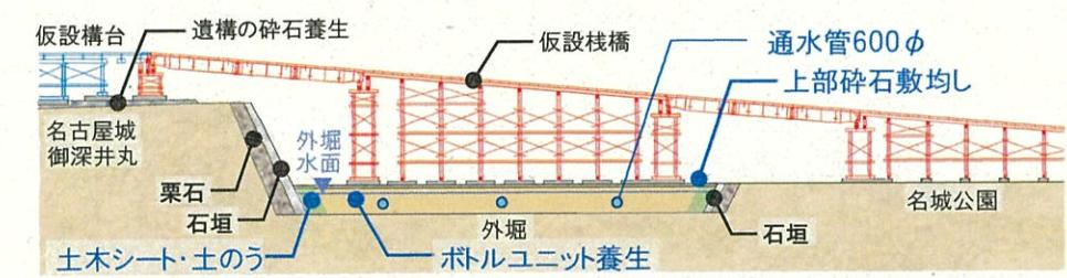
図2-3-8 仮設桿橋とボトルユニットによる外堀養生(断面図)
