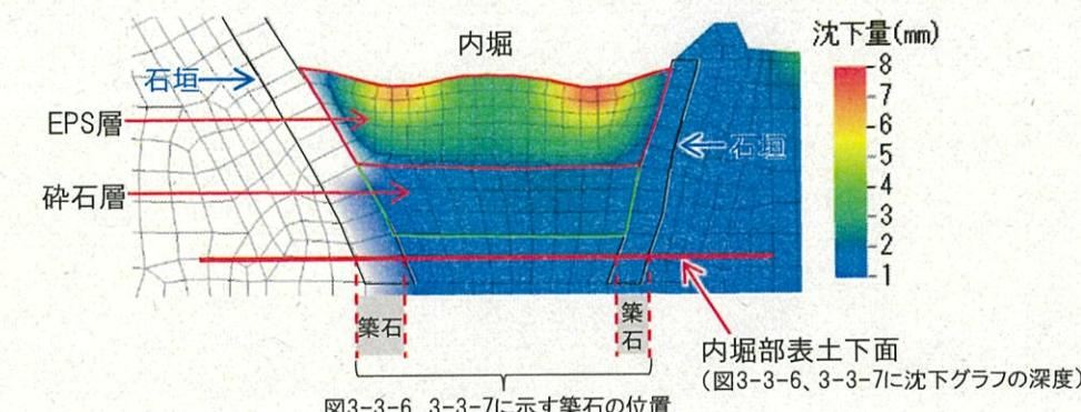
図3-3-5 断面モデルの沈下の影響度合い(内堀部の拡大図)
