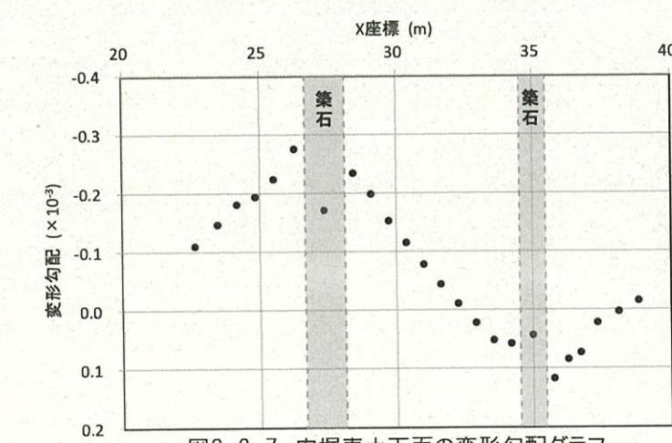
図3-3-7 内堀表土下面の変形勾配グラフ
