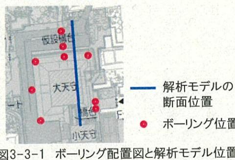
図3-3-1 ボーリング配置図と解析モデル位置
