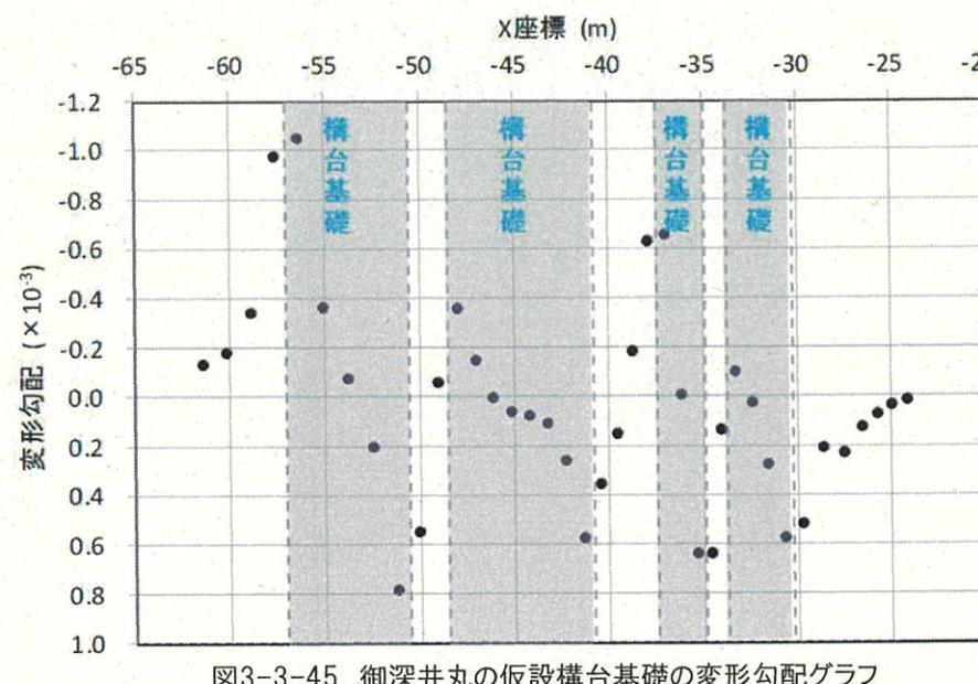
図3-3-45 御深井丸の仮設構台基礎の変形勾配グラフ
