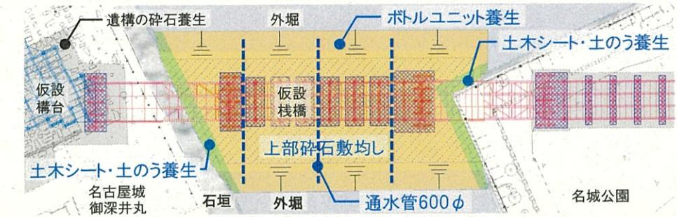
図2-3-7 仮設桿橋とボトルユニットによる外堀養生(平面図)
