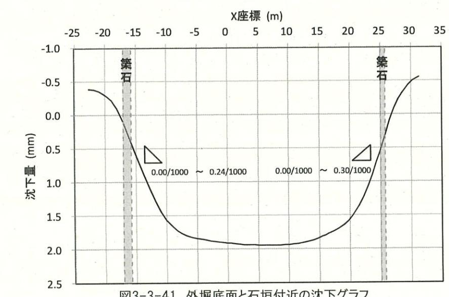
図3-3-41 外堀底面と石垣付近の沈下グラフ
