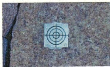
図3-4-3 測量点のターゲットの例
