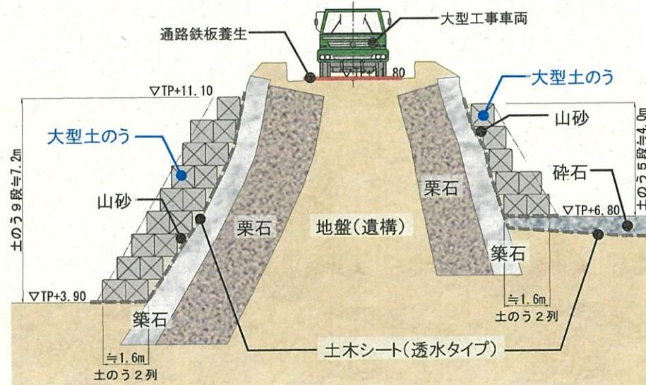
図2-3-5 鶴の首石垣の大型土のう養生
