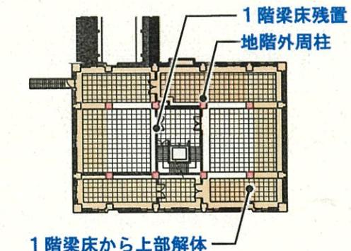
図2-1-10 小天守解体部分1階平面図
