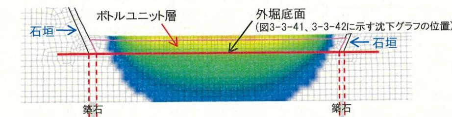
図3-3-40 断面モデルの沈下の影響度合い(外堀部の拡大図)
