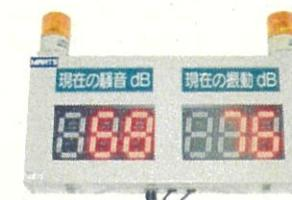
図3-4-8 振動レベル表示板の例
