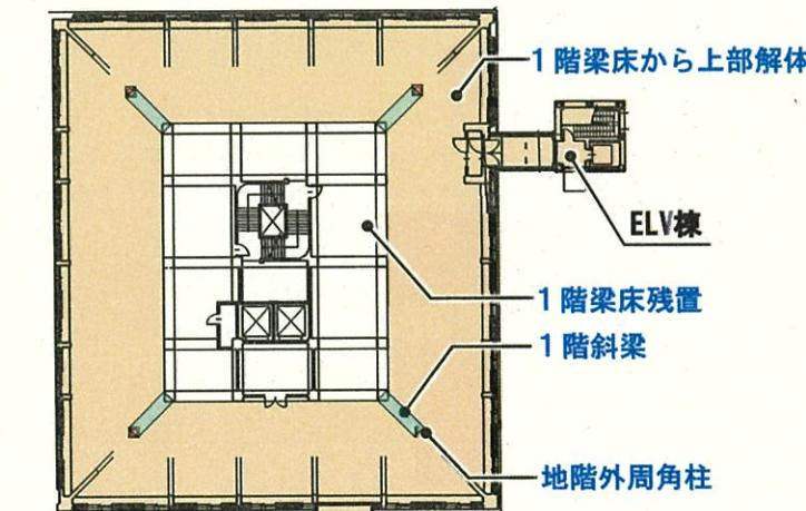
図2-1-5 大天守解体部分1階平面図(ELV棟含)
