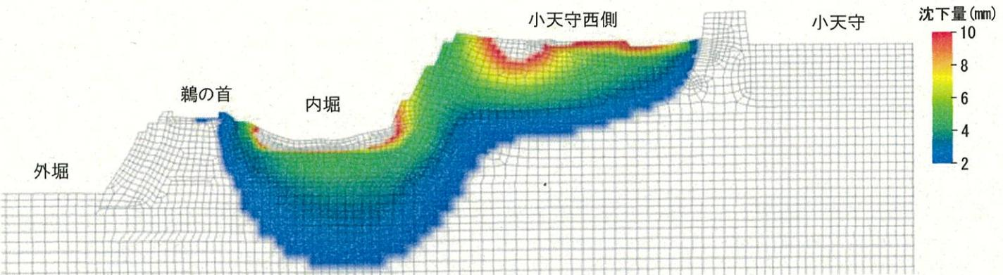
図3-3-17 断面モデルの沈下の影響度合い(全体)
