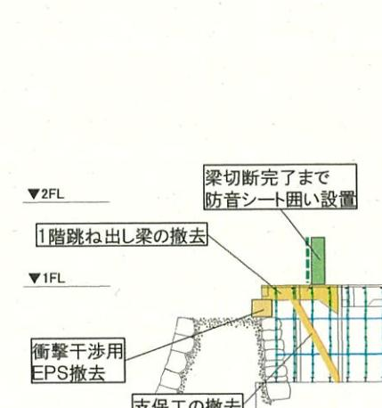
図2-5-2 外周跳ね出し部の解体ステップ図
