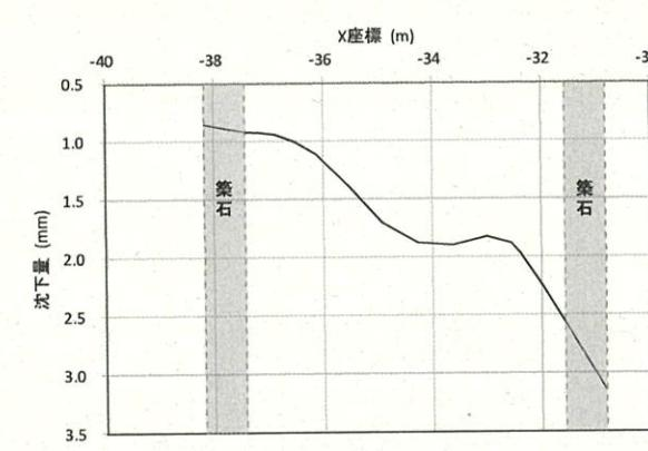
図3-3-19 表土下面の沈下グラフ
