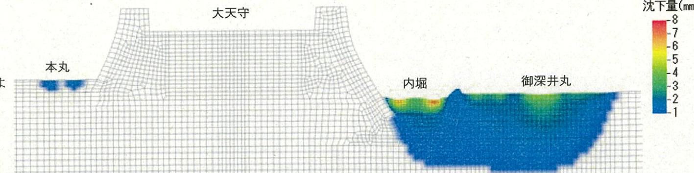
図3-3-4 断面モデルの沈下の影響度合い(全体)
