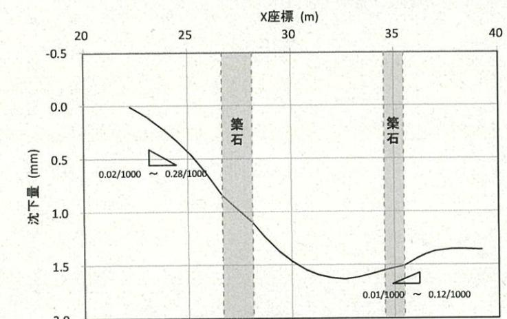
図3-3-6 内堀表土下面の沈下グラフ
