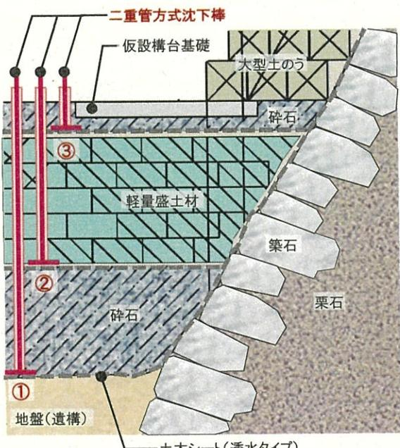
図3-4-6 二重管方式沈下計測棒のイメージ
