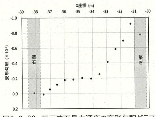
図3-3-22 石垣沈下最大深度の変形勾配グラフ
