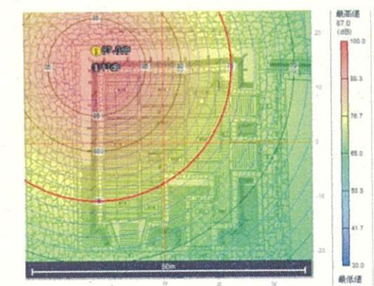
図3-2-3 大型ブレーカー工法の振動予測
