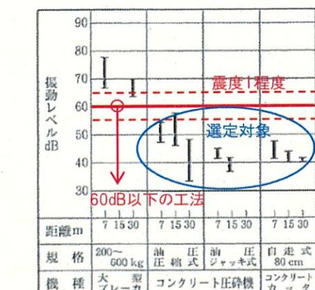
図3-2-1 解体工事による振動レベル例
