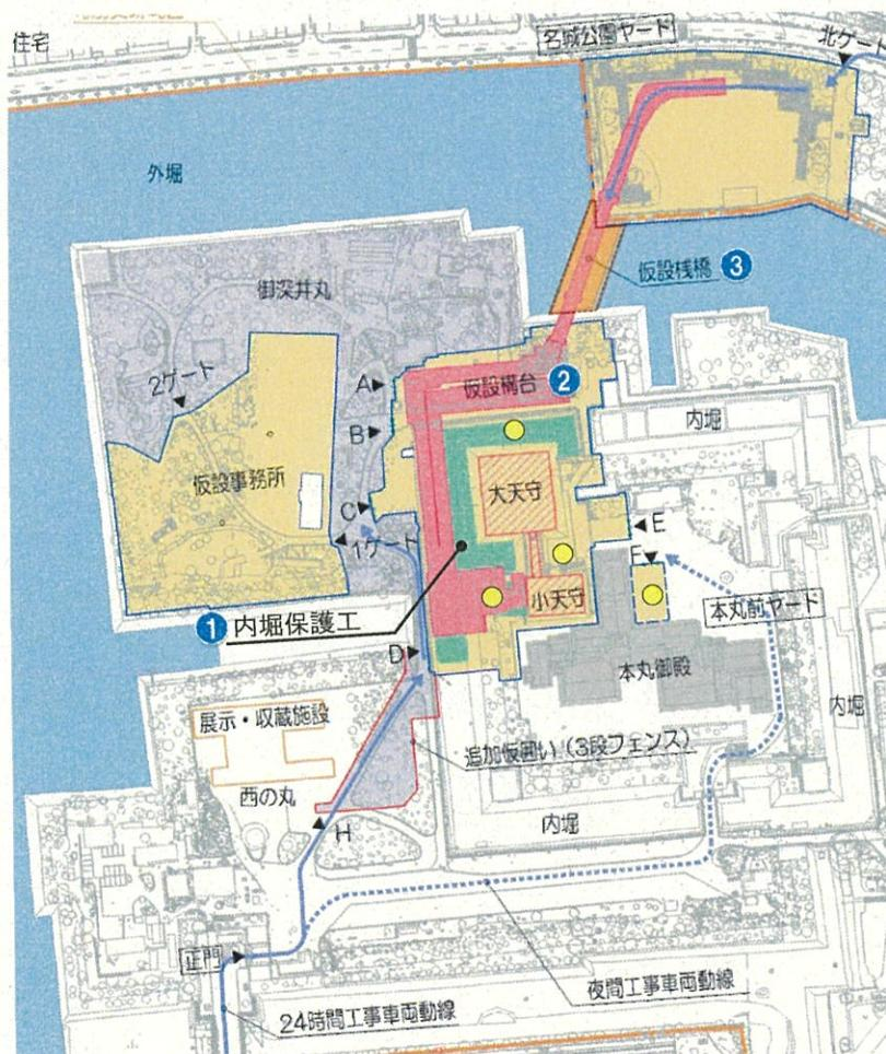
図2-2-1 解体工事 仮設計画配置図
