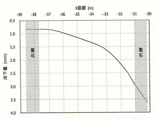
図3-3-20 石垣沈下最大深度の沈下グラフ
