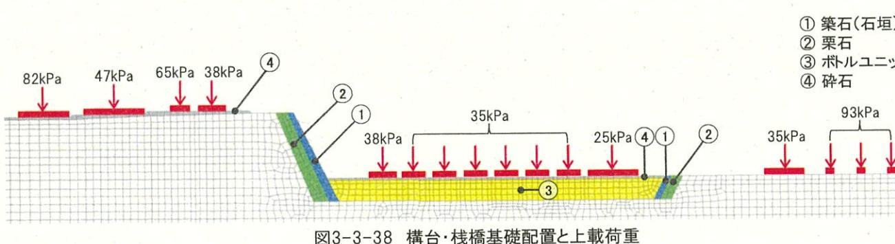
図3-3-38 構台・桟橋基礎配置と上載荷重
