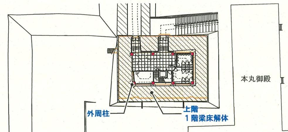
図2-1-9 小天守解体部分地階平面図
