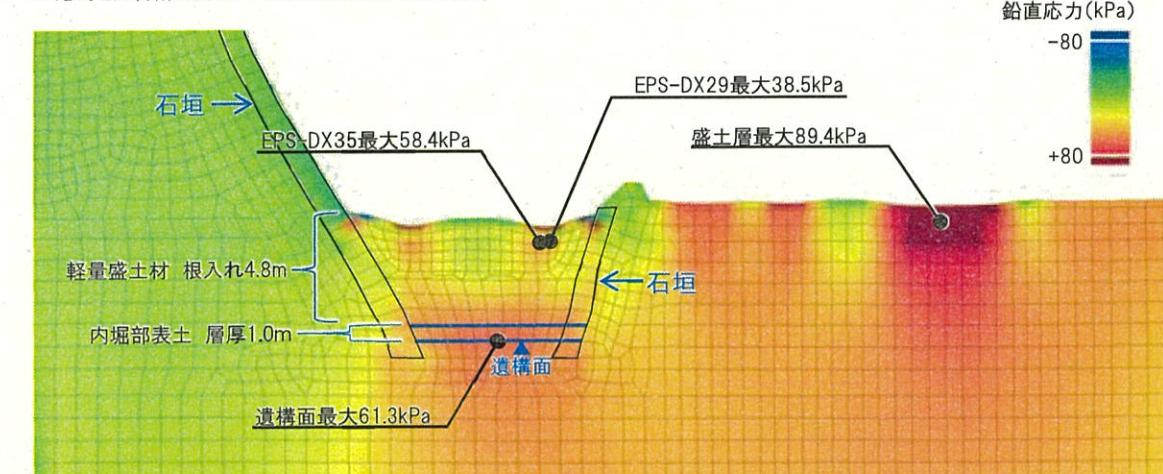
図3-3-12 鉛直応力の影響度合い(センター図)-(内堀部～御深井丸)
