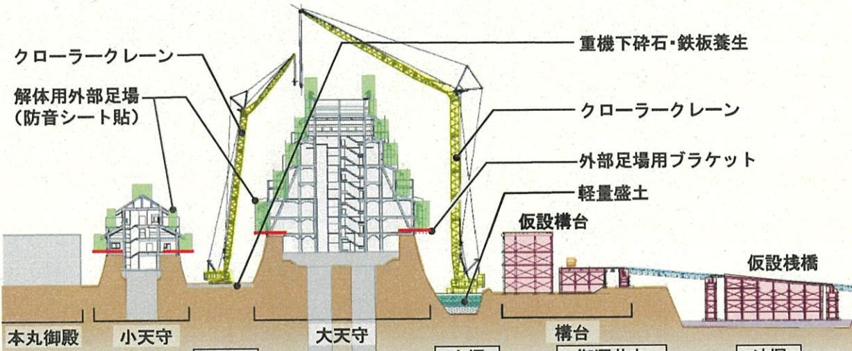
図2-2-2 仮設構台、仮設桟橋等設置イメージ図
