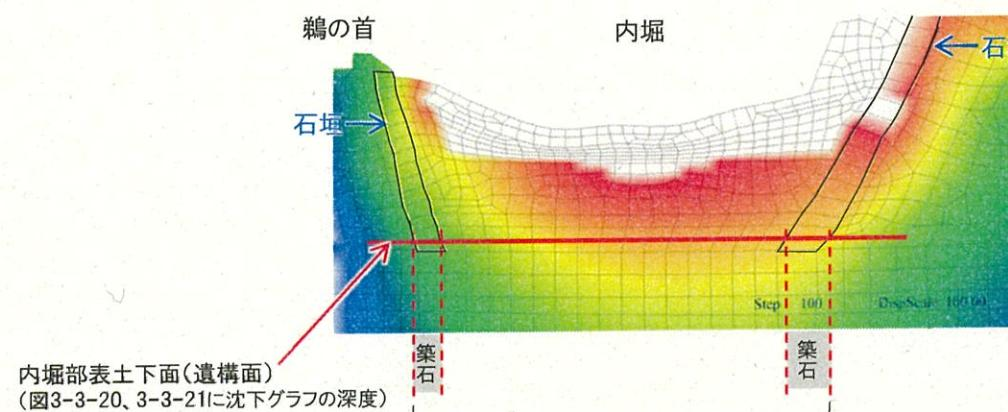
図3-3-23 断面モデルの沈下の影響度合い(内堀部の拡大図)
