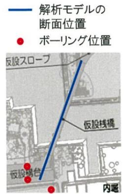
図3-3-36 ボーリング配置図と解析モデル位置
