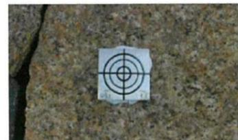
図3-4-3 測量点のターゲットの例
