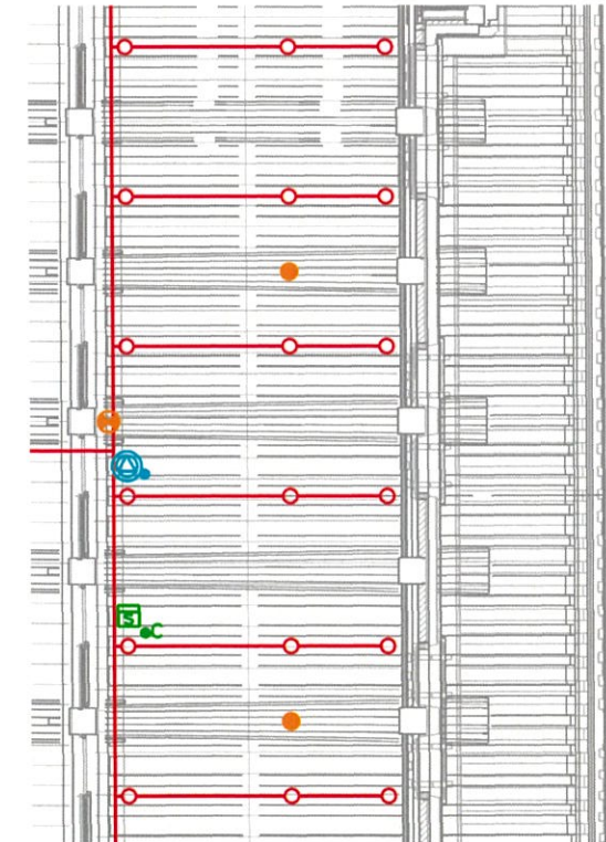
図-2.5 防災設備プロット図(2階)-2
