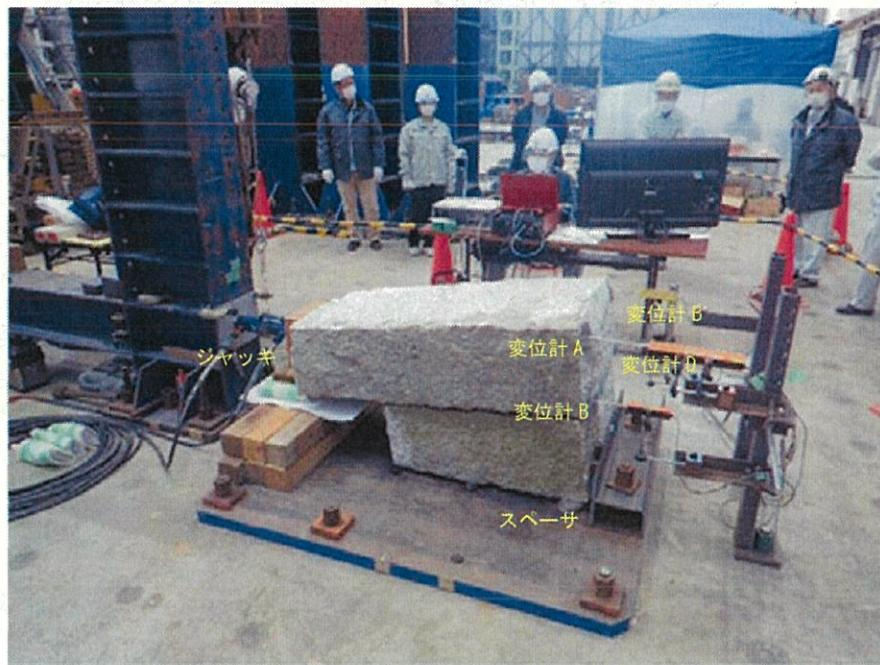
写真-3.1 実験装置への石材の設置状況
