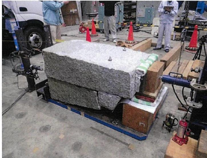
写真 4 逆石安定性確認試験状況
