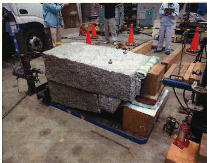
写真 4 逆石付加工法の有効性検証試験状況
