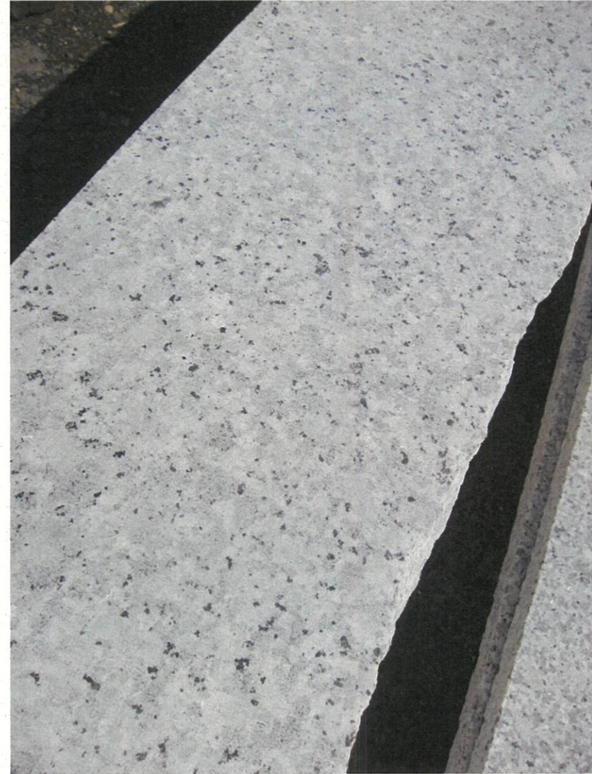
写真3 蛭川みかげ石サンプル①(写真左:全景、写真右:近景)
